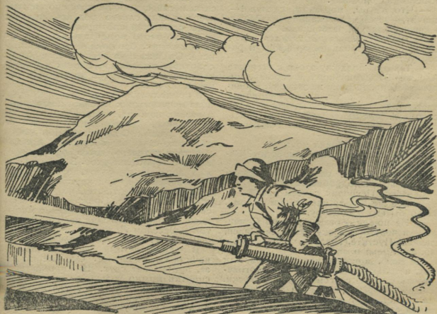
лическим способом. Мониторы выбрасывали 40-метровую струю воды (рис. к стр. 50).
